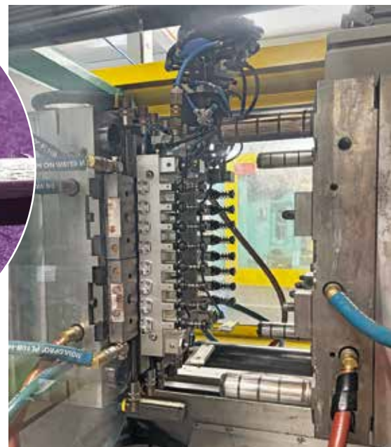
Für den Einsatz in Lufttreibungsdämpfern entstehen im 16fach-Werkzeug präzise umspritzte Kolben, deren drei Öffnungen ausschlaggebend für das Dämpfungsverhalten sind. Rechts der Greifer bei der Bauteilentnahme.
