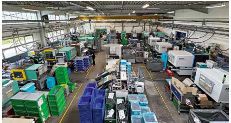
Am Standort Ottersweier produzieren 28 Spritzgießmaschinen mit bis zu 6.000 kN Schließkraft Komponenten und Baugruppen sowohl für Schwesterunternehmen als auch für externe Kunden.
