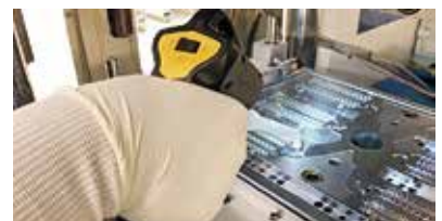
Reinigung einer Spritzgießform mit einem Trockeneisstrahlgerät.
